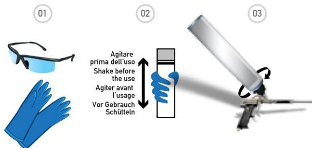
Tenere l'ugello di fuoriuscita dell'adesivo ad una distanza di circa 2 cm dalla superficie del pannello isolante da incollare.
